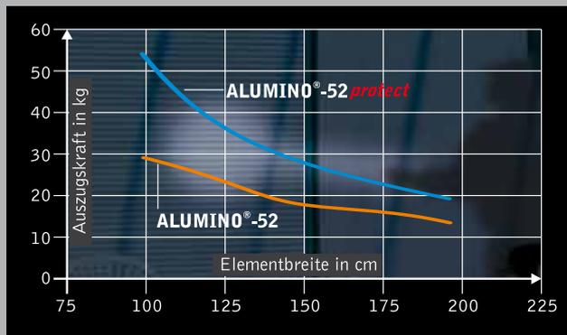
Auszugskräfte aus Standard-Führungsschiene bei Profil ALUMINO 52 protect
