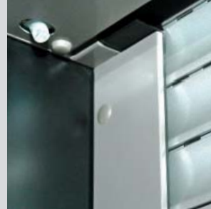
Infrarot-Sensor der GENIO-Näherungssensoren
