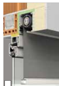
zipSCREEN.2 Basis INTEGRO/ rollSCREEN verputzbarer Kasten (Abb. zipSCREEN.2 Montage im Wärme- dämmverbundsystem)
